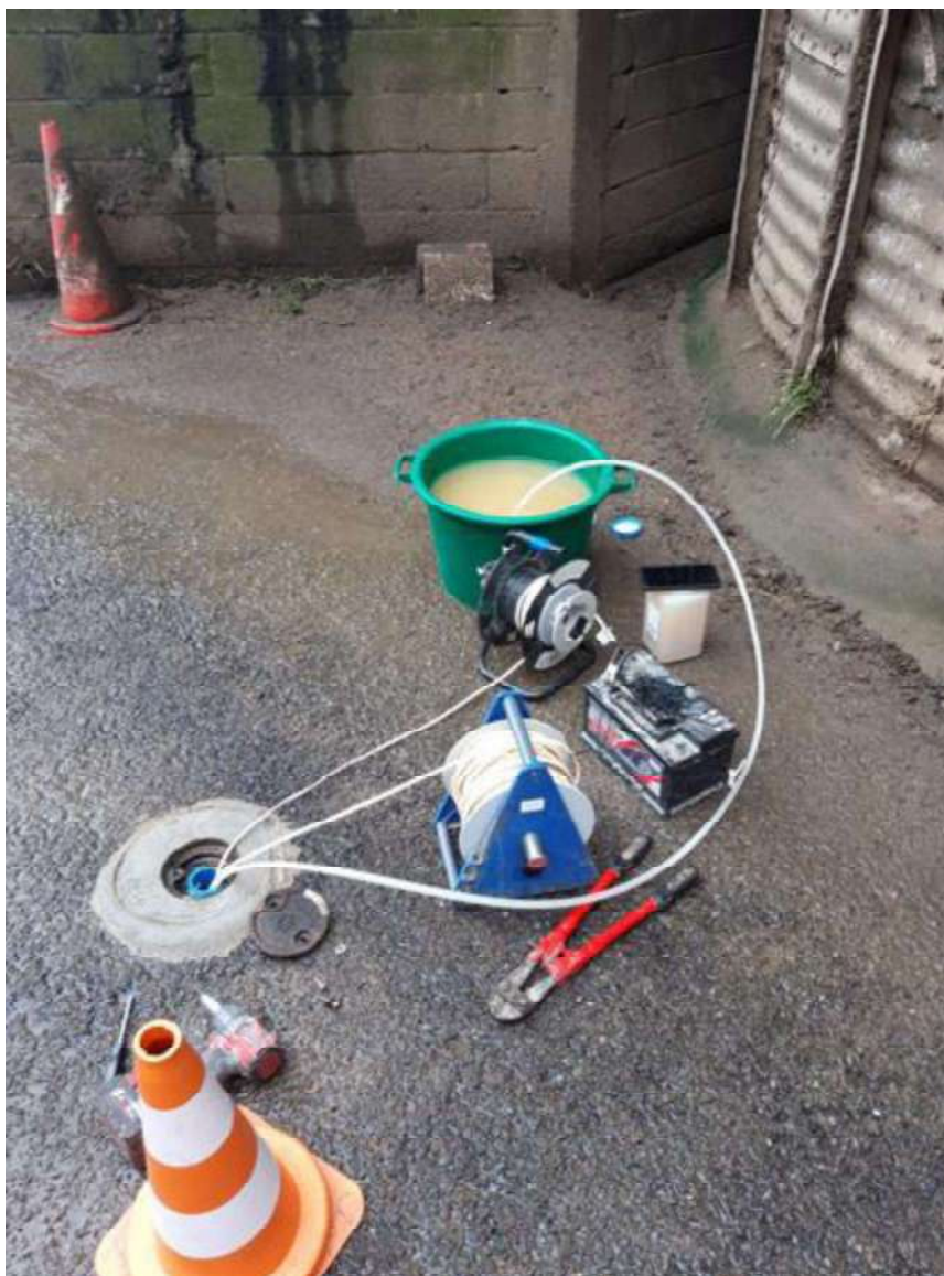
FIGURE 15 : PHOTOGRAPHIE DE L'ESSAI LEFRANC EN Pz1
